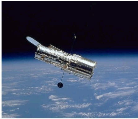
HST (Hubble Space Telescope) Διαστημικό τηλεσκόπιο Hubble κατοπτρικό διαμέτρου 2,4 m
